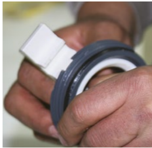
Dayama içindeki küre contası el ile çıkartılır.
