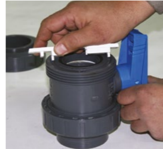
Vana kol kapağı altındaki tırnaklar sıkıştırma parçası yatağı (sekman) üzerindeki yuvalarına oturtulur.
