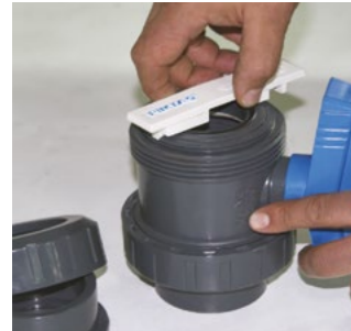
Sekman saat yönü tersine çevrilererek çıkartılır.
