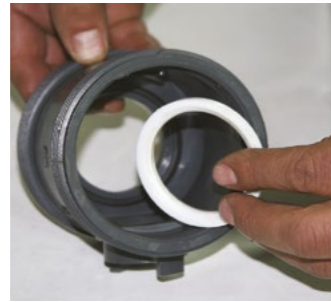
Gövde içindeki küre contası ile alınır.
